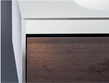
Furnierte Holzoberflächen bestehen aus einer hochwertigen P3 ( Bezeichnung der Verleimung ) verleimten Spanplatte, die beidseitig mit 0,6 - 0,7 mm Echtholz Eiche bzw. Nussbaum furniert (Gesamtdicke 19 mm) und mit hochwertigem 2-Komponenten-Lack seidenmatt lackiert wurde.
